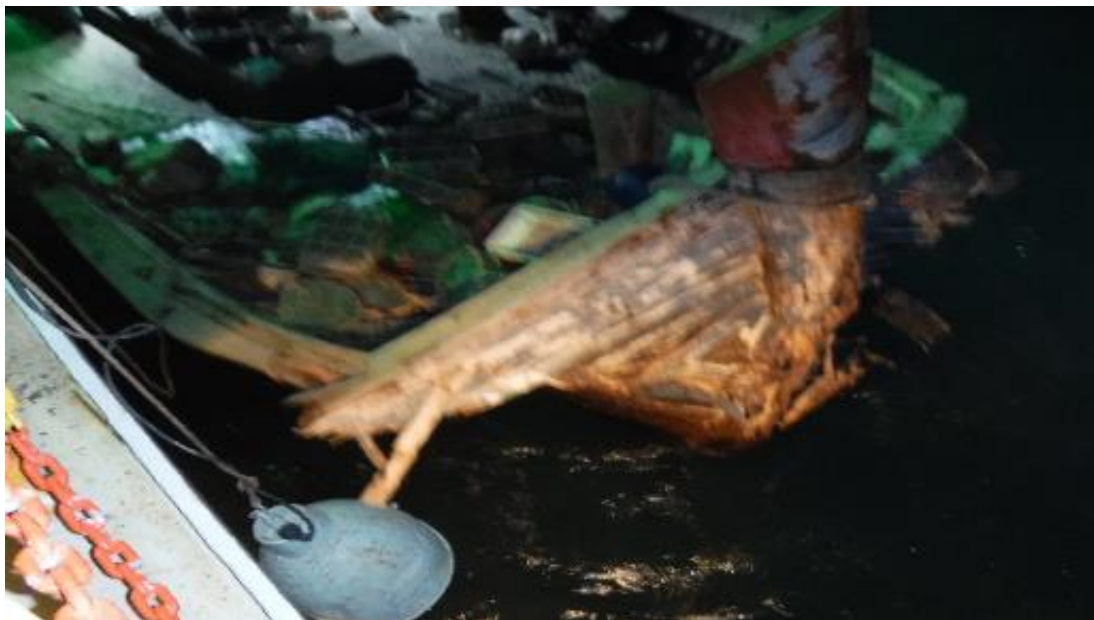
图 11: L 船船艏受损
