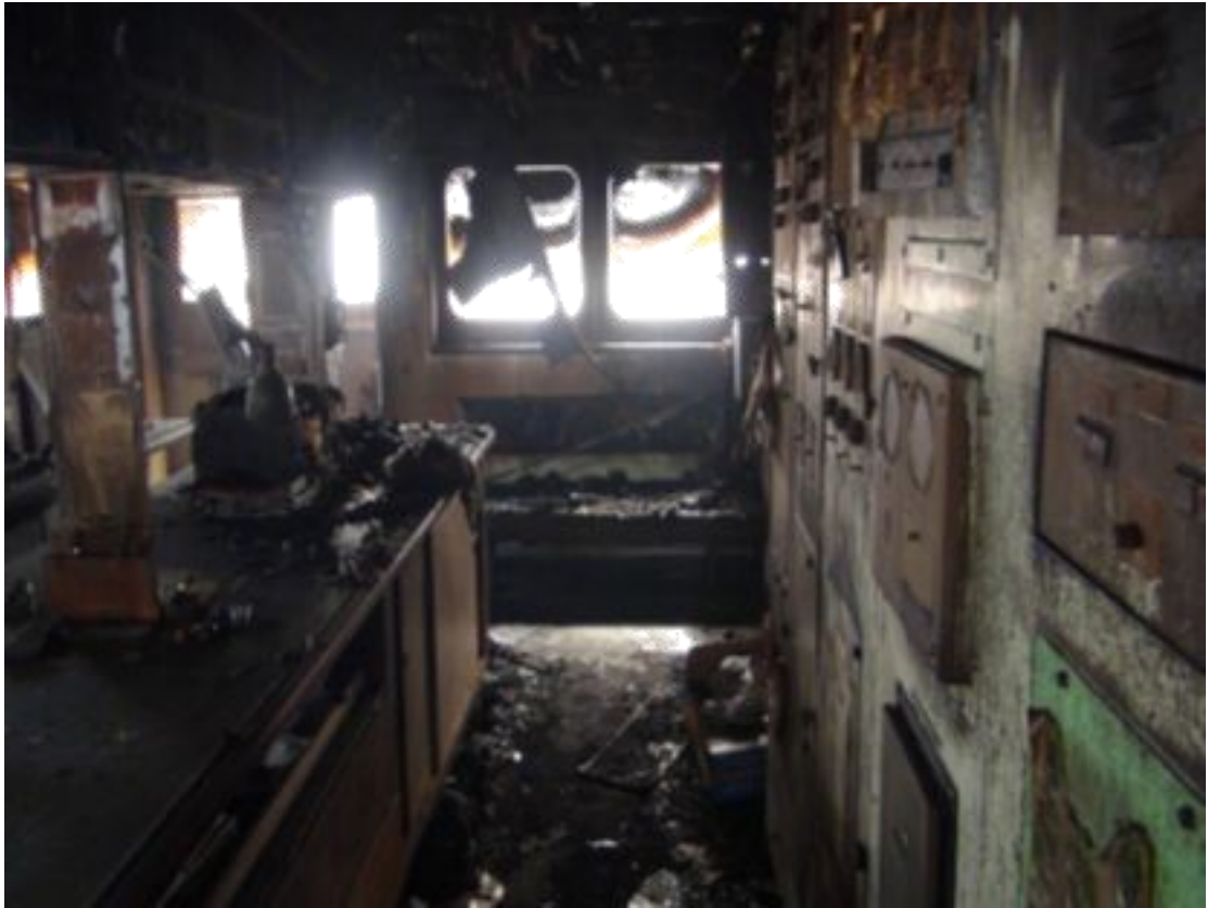
图 3：“S”轮驾驶台区域设施设备不同程度损坏
