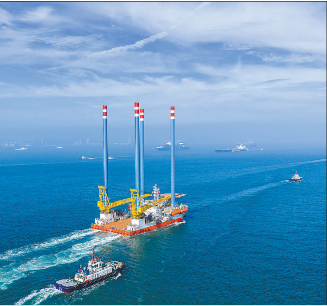
7月23日，由青岛海西重机有限责任公司新建的海上油田200人生活辅助平台，从山东青岛海西重机港口出港，到青岛前海锚地南水域开展平台试航任务。该平台有1000平方米的甲板面积供油田服务使用，并根据作业需求设置2台100吨级绕柱式海事起重机。青岛海事部门通过现场核查督促船舶落实安全主体责任，完善防污染、警戒值守、应急处置等措施，保障试航顺利。
