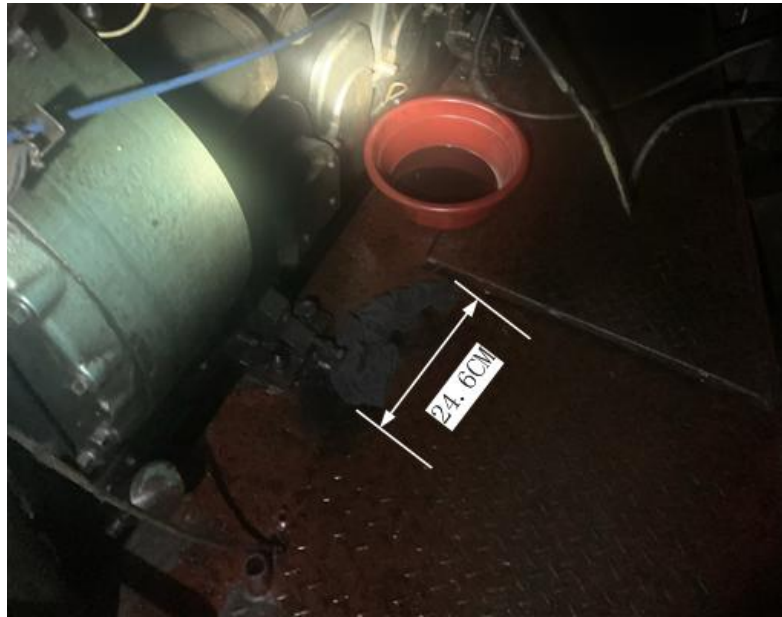
图 11：花铁板上放置的抹布燃烧残留物
