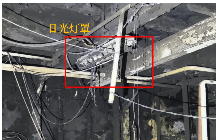
图 7：右主机右前方上部日光灯罩及灯管
