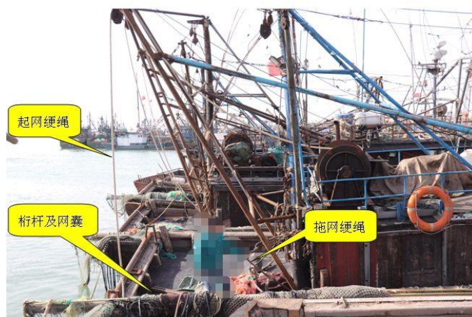
图 6：L 船船长演示同型渔船的网具组成
