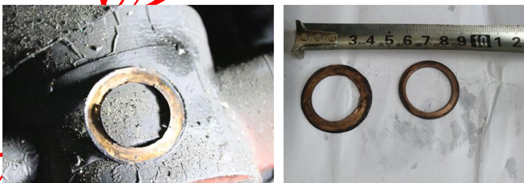
图 9: 破损铜质垫圈（外径大者）与正常垫圈对比图
